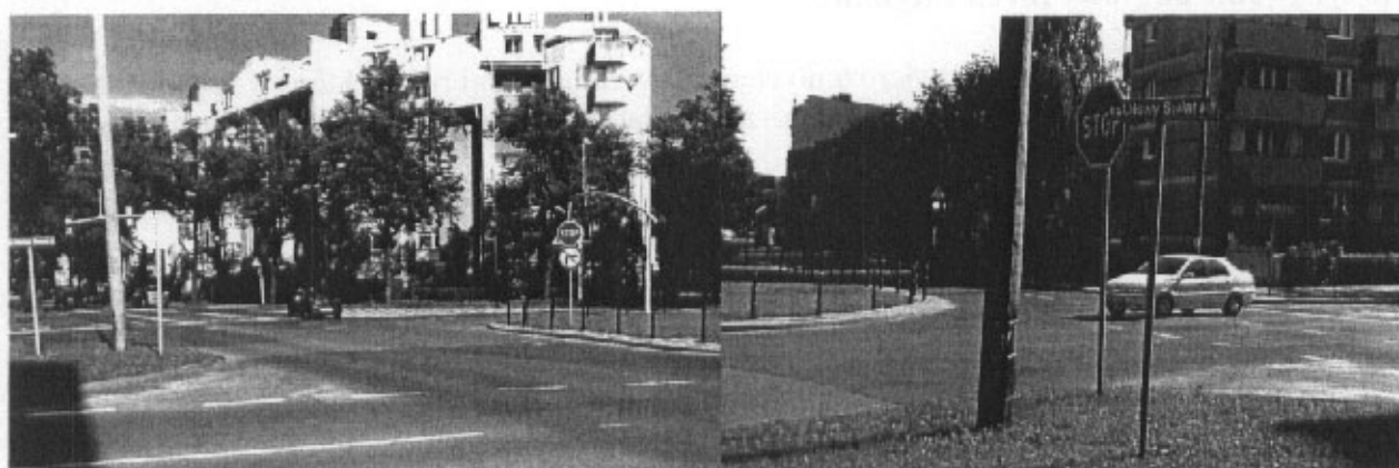
Rys 2. Brak linii P – 12 w uzupełnieniu znaku B-20 (centralna część skrzyżowania), brak znaku B-22 pod znakiem B-20 (centralna część skrzyżowania – analogicznie jak dla kierunku przeciwnego)
