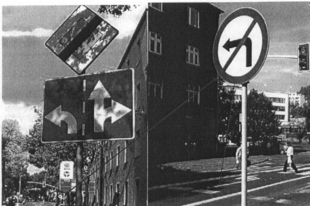
Rys 1. Zastosowanie znaku B-21 „zakaz skrętu w lewo” w sytuacji jednoczesnego wydzielienia relacji skrętu w lewo
